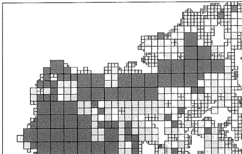
La relación entre la potencia calculada para cada nivel de tensión y el área de la cuadrícula correspondiente a cada rango de densidad de carga constituirá su densidad de carga para cada nivel de tensión.
